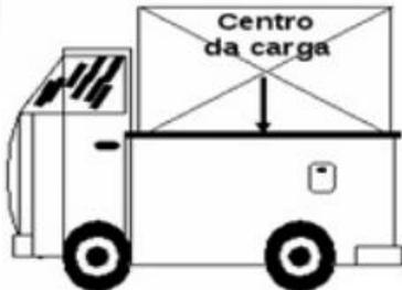
O centro de carga (D) é a medida tomada a partir da face anterior dos garfos até o centro da carga. Tem-se como norma especificar as empilhadeiras até 4.999 a 50 cm de centro de carga e, dessa capacidade em diante, 60 cm.
